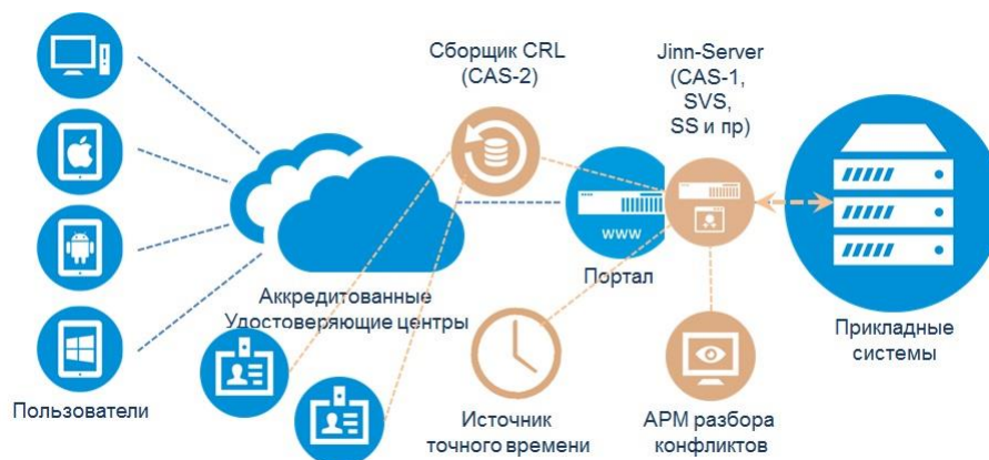
Рис. 1. Общая схема разворачивания компонентов ПАК "Jinn-Server"
